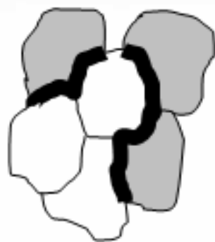
Рис. 2.5. Перемещение зёрен относительно друг друга за счет проскальзывания зерна по границам
